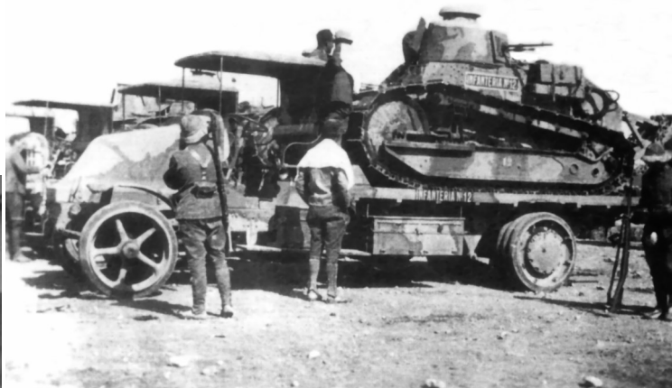
Imagen 10.- Desde el principio de su desarrollo, los carros eran transportados sobre camiones con plataformas o tractores, siempre que la situación táctica y el terreno lo permitían, dado el elevado desgaste de los sistemas de orugas. De hecho, tanto los Renault como los Schneider contaban con sus propios tractores.
