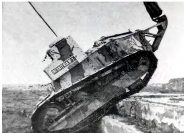
Imagen 7.- Vista del único Renault de mando o transmisiones TSH, con que fue dotada la Compañía de Carros de Asalto de Infantería. En los costados estaba rotulado como INFANTERÍA Nº 1 . Carecía de armamento y de torre
